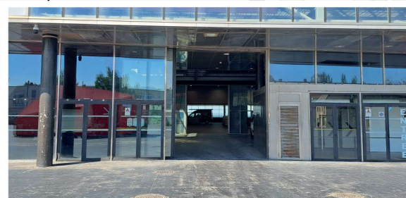
② Déchargement par porte centrale dimensions 4,00 m (l) x 4,40 m (h)
